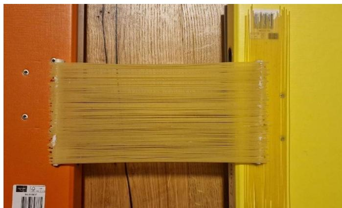
Abb. 39: Fertige Capellinbrücke mit zwei Stützen auf zwei Ordnern
