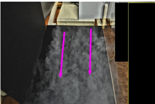
Abbildung 20 Verhalten des Nebels im Windkanal ohne Bebauung mit leichten Verwirbelungen (Perspektive: oben)
