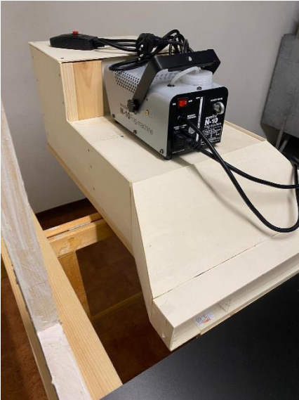
Abbildung 13 Wind-Nebel Erzeugungsvorrichtung (eigenes Foto)
