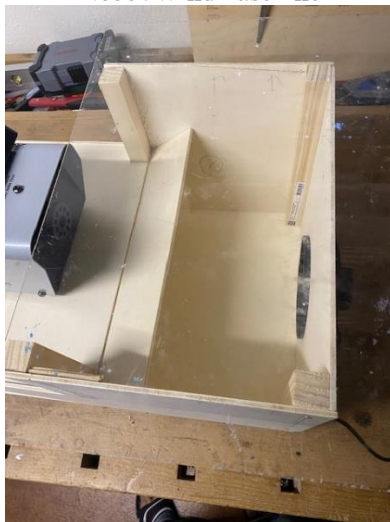
Abbildung 58 Integrierung von Nebelmaschine, Ventilator und Holzvorrichtung
