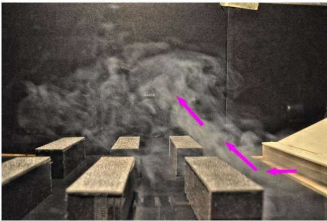
Abbildung 42 Nebel wird von der Fassade der Zeilensiedlung quer nach oben umgelenkt
