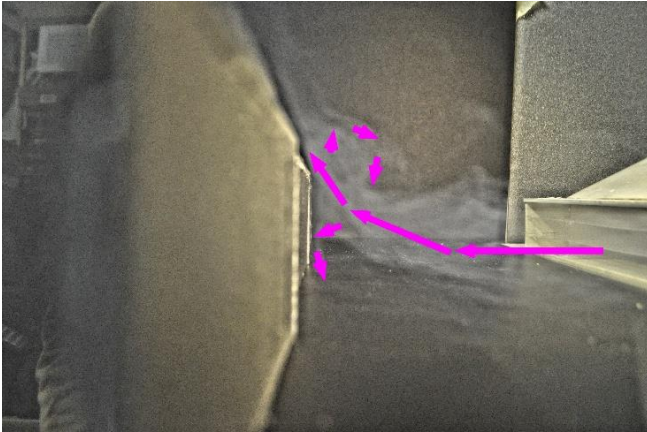
Abbildung 22 Ablenkung des Luftstroms vor Luvseite der Blockrandbebauung
