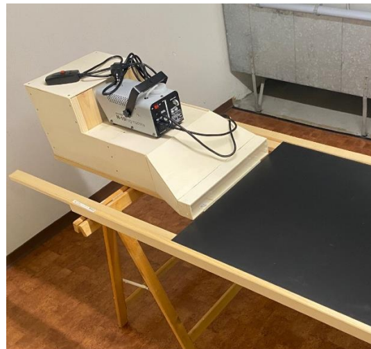
Abbildung 59 Die fertige Nebel/Windvorrichtung
