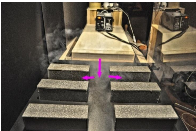
Abbildung 44 auch gelangt in die Zwischenräume quer zur Windrichtung (Strassenschluchten)
