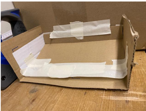
Abbildung 56 Prototyp des bodennahen Ausganges der Nebel/Windmaschine
