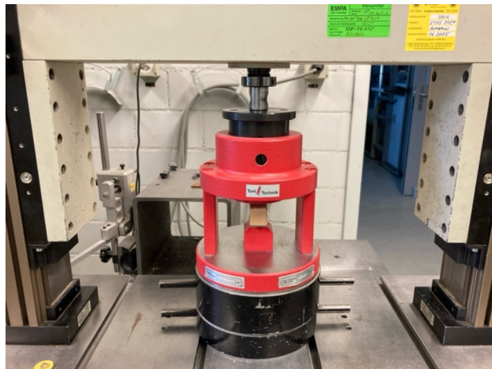
Abbildung 24 Versuchsaufbau Druckfestigkeit (Quelle: Raphael Kuhn, 08.08.2025)
