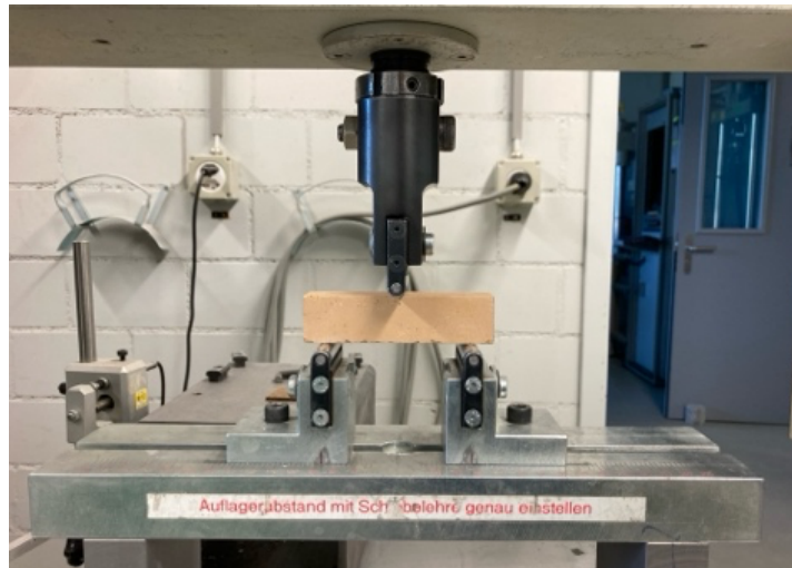
Abbildung 23 Versuchsaufbau Biegezugfestigkeit (Quelle: Raphael Kuhn, 08.08.2025)
