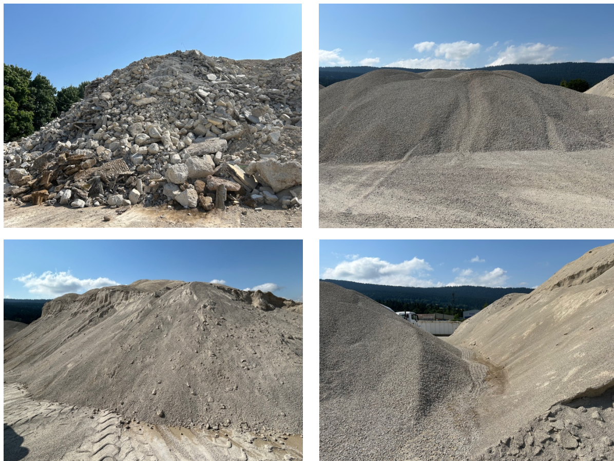
Figure n°33, n°34, n°35 et n°36, Tas de béton concassé, Coffrane, source : Charles-Henri de Pourtalès
